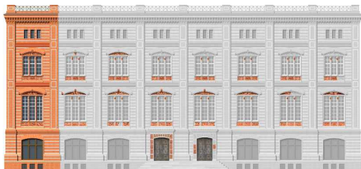
F5: Nordfassade: Achse 1 = Musterfassade und Achsen 2 – 8 (grau) mit Einfügungen vorhandener Reliefplatten und Terrakotten
